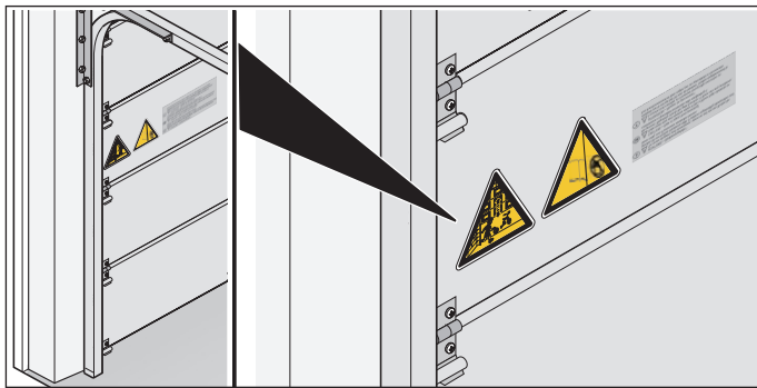
Abb. 1.2 Aufkleber am Torblatt anbringen
