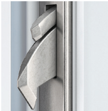
Sicherheitsschwenkriegel (unten) und Dichtigkeitselement (oben) – EAV3 Verriegelung
