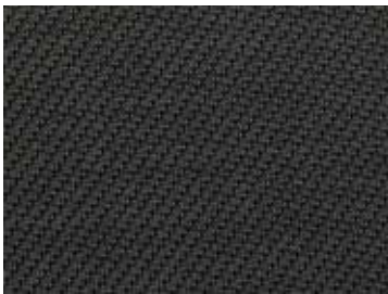
Glasfasergewebe Gewebe aus PVC-ummantelten Glasfasergarnen, Webart Sergé
