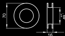
Schiebetürmuschel für Glastür EZ1706 GS – EZ1706 GSH (verschraubbar) Bohrdurchmesser im Glas: 50 mm, TS: 8-11 mm Farbe: Edelstahl matt
