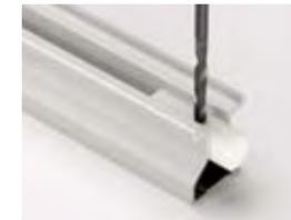
Patente Bohrschablonen nutzen und Profile bohren.
