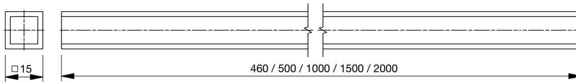
8688- Rohr für Stabilisationsstange
